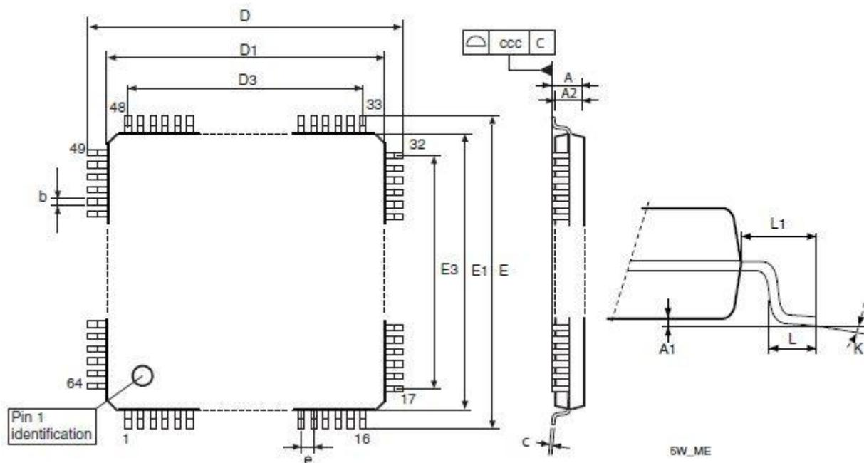
图 25 LQFP48-10x10mm, 64 脚低剖面方形扁平封装图
