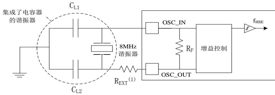
图 14 使用 8MHz 晶体的典型应用
