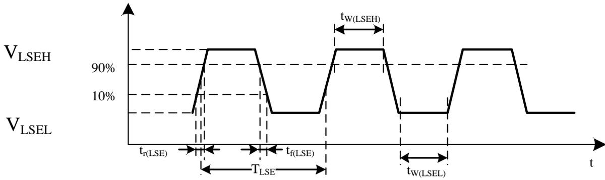
图 13 低速外部时钟源交流时序图
