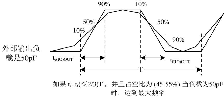
图 18 输入输出交流特性定义
