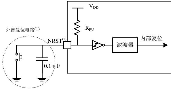
图 19 建议的 NRST 引脚保护
