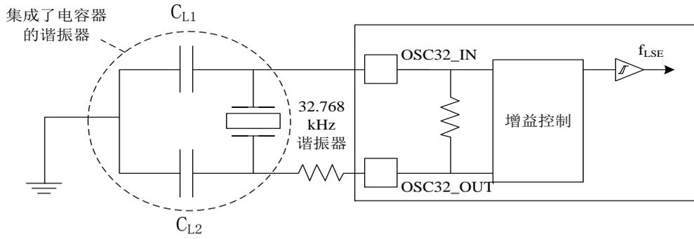
图 15 使用 32.768kHz 晶体的典型应用
