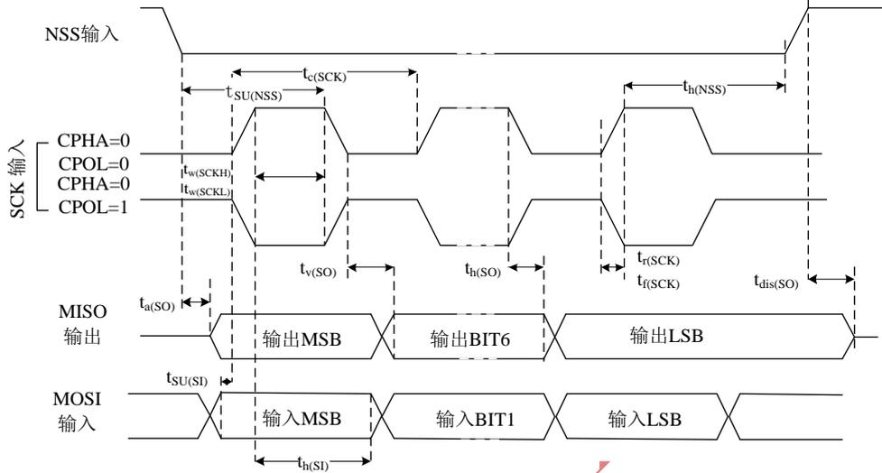
图 22 SPI 时序图-从模式和 CPHA=0
