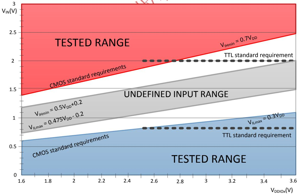
图 17 5V 容忍(FT 和 FTf)的 I/O 输入特性
