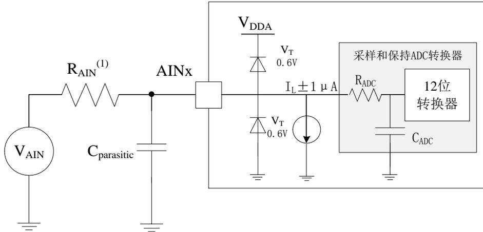
图 21 使用 ADC 典型的连接图
