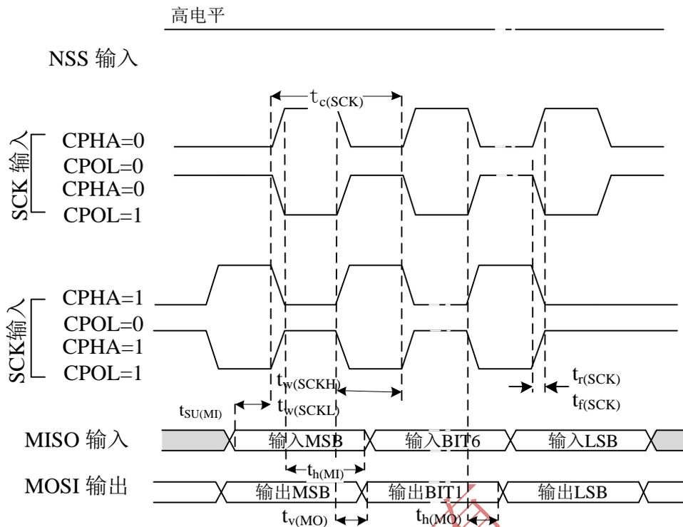
图 24 SPI 时序图-主模式<sup>(1)</sup>
