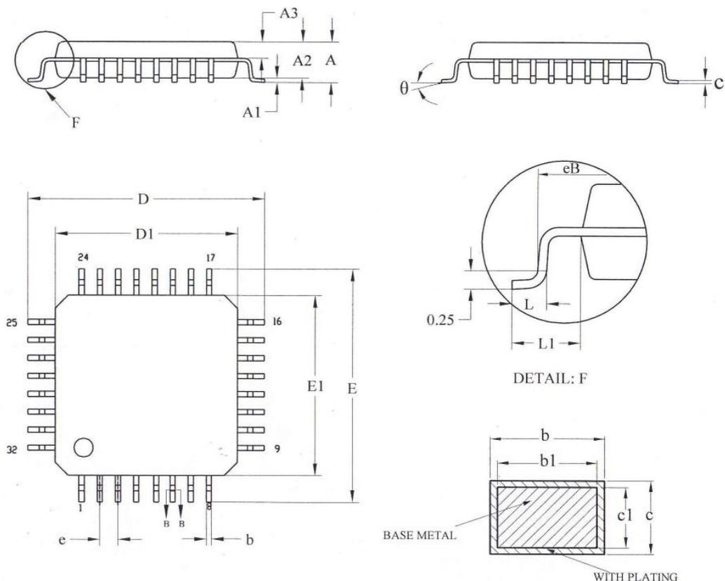
图 29 LQFP32-7x7 mm, 32 脚低剖面方形扁平封装图
