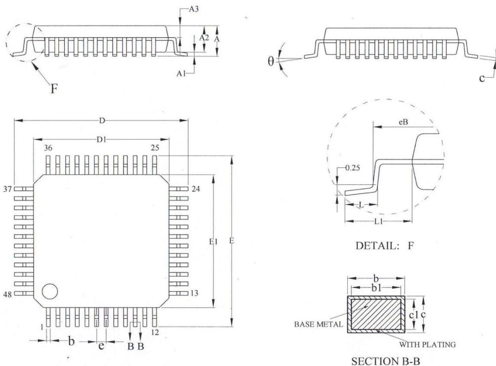
图 27 LQFP48-7x7mm, 48 脚低剖面方形扁平封装图
