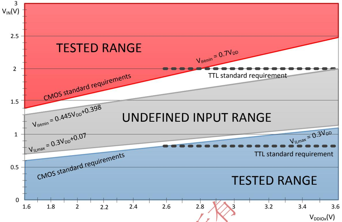
图 16 TC 和 TTa 的 I/O 口输入特性
