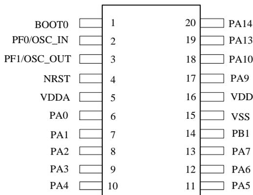
图 6 TSSOP20 引脚封装脚位图
