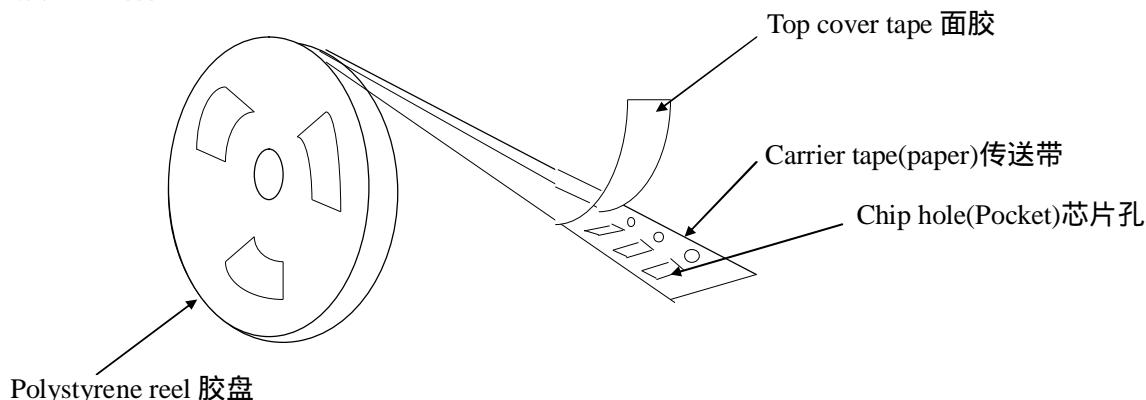
塑胶带尺寸结构(适合‘0805~1812’型产品)
