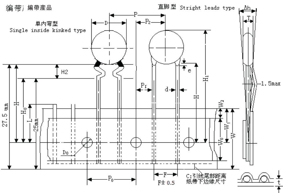
注: 引脚距离和引线形式常规按EIA和JIS的标准执行。同时我们可以根据客户要求, 做出符合客户使用的引脚距离和引线形式。
