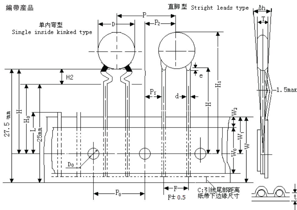
注：引脚距离和引线形式常规按EIA和JIS的标准执行。同时我们可以根据客户要求，做出符合客户使用的引脚距离和引线形式。
