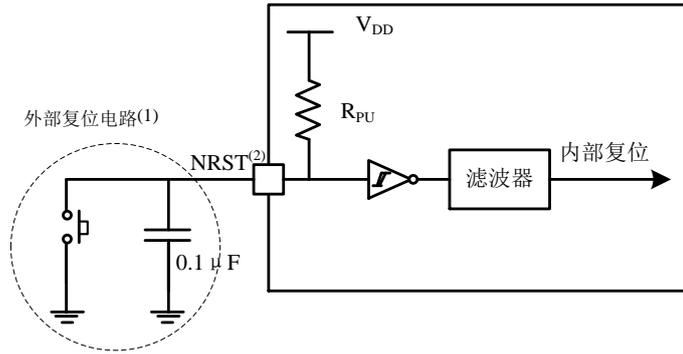
图 22 建议的 NRST 引脚保护
