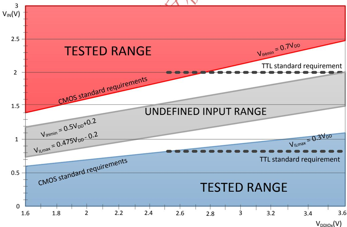
图 20 5V 容忍(FT 和 FTf)的 I/O 输入特性
