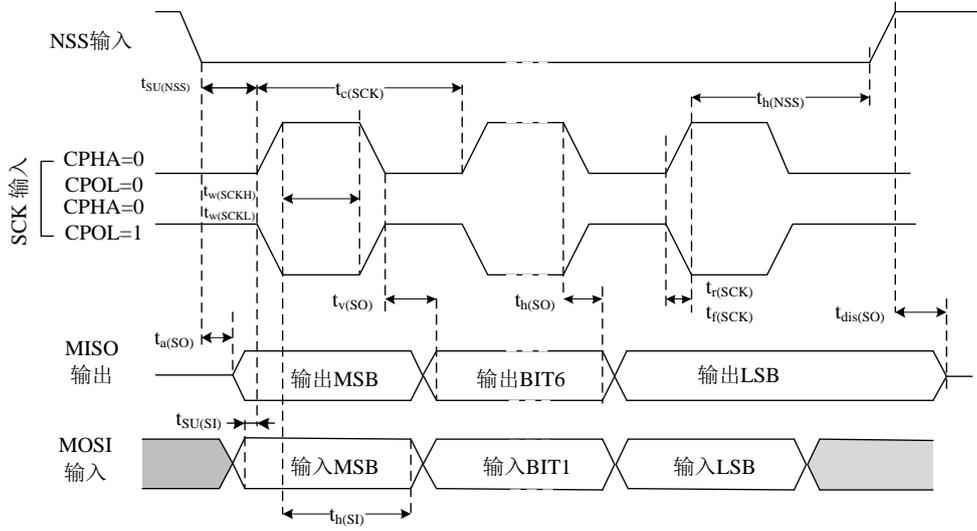
图 25 SPI 时序图-从模式和 CPHA=0
