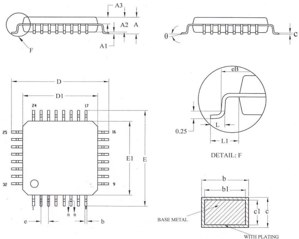
图 31 LQFP32-7x7 mm, 32 脚低剖面方形扁平封装图
