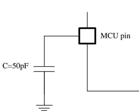
图 9 引脚的负载条件
