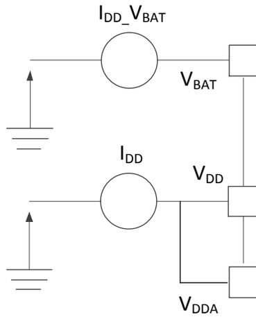
图 12 电流消耗测量方案
