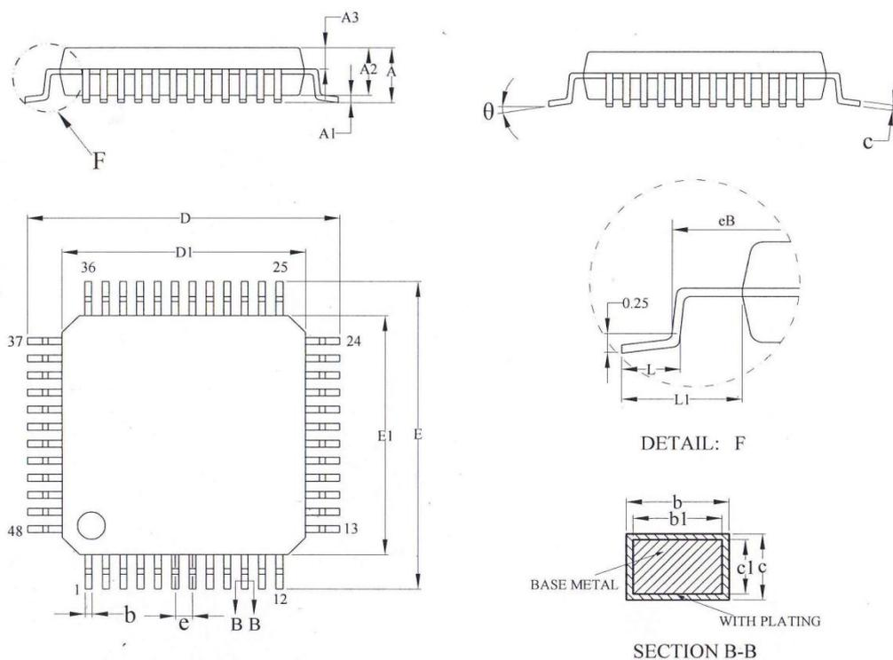
图 29 LQFP48-7x7mm, 48 脚低剖面方形扁平封装图
