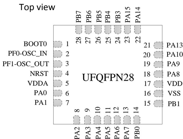
图 6 UFQFPN28 引脚封装脚位图
