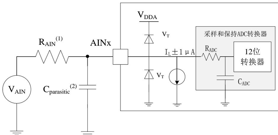
图 24 使用 ADC 典型的连接图
