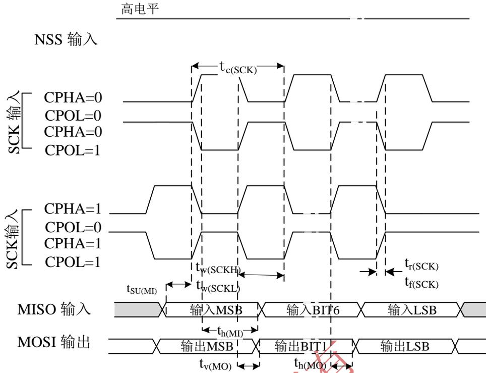
图 27 SPI 时序图-主模式<sup>(1)</sup>
