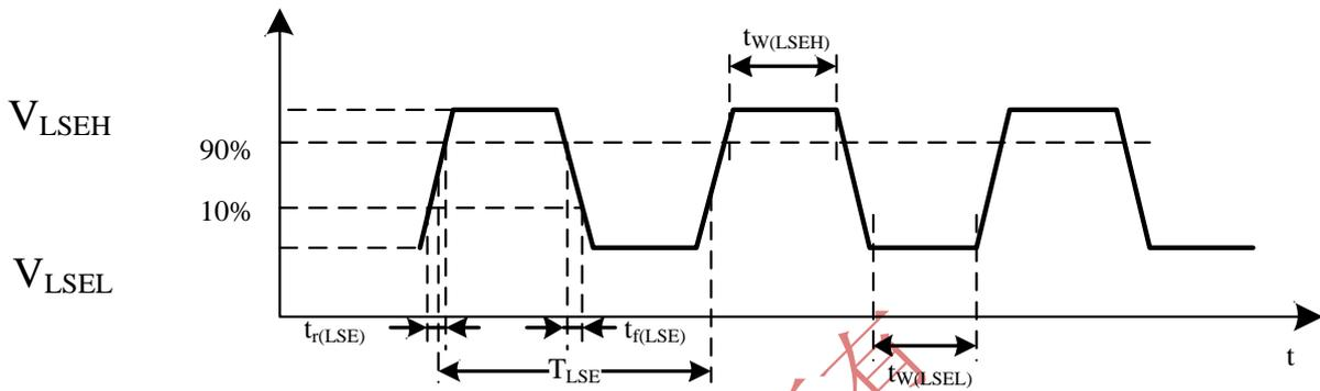
图 14 低速外部时钟源交流时序图
