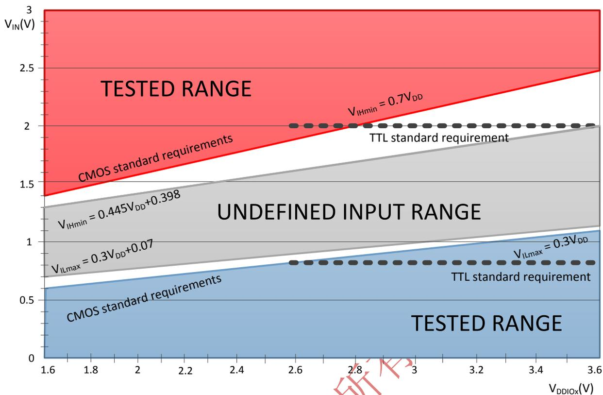
图 19 TC 和 TTA 的 IO 口输入特性
