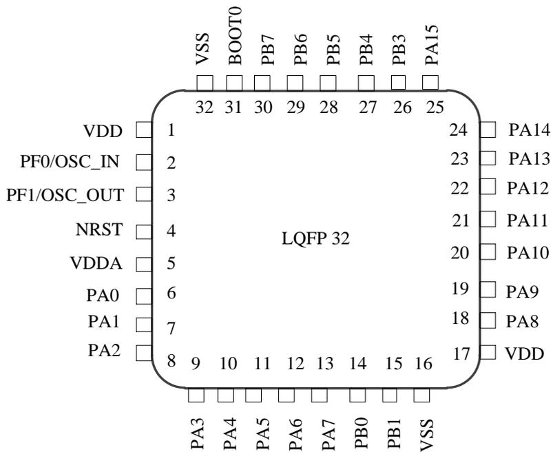
图 4 LQFP32 引脚封装脚位图
